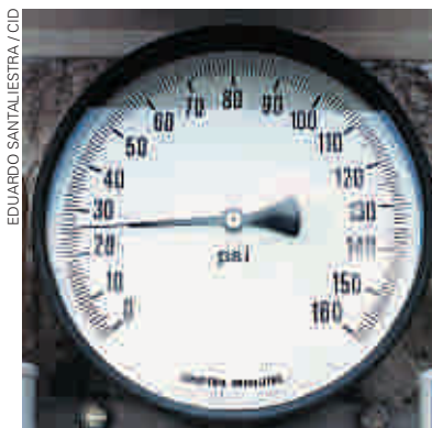
Os manômetros utilizados nos postos de serviços medem a pressão do ar no interior dos pneus.
