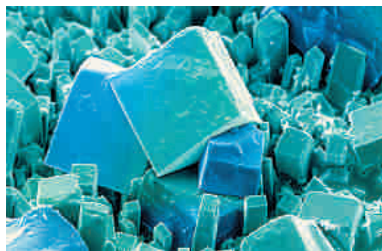
Cristais de \text{NaCl} colorizados artificialmente, vistos ao microscópio. Aumento de 120 vezes.
