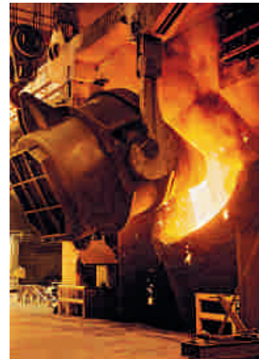
Interior de fundição, vendo-se o caldeirão despejando metal derretido num forno.
